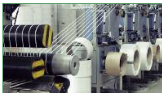
Фиг.4 Удължителен процес на Secugrid® ребра
