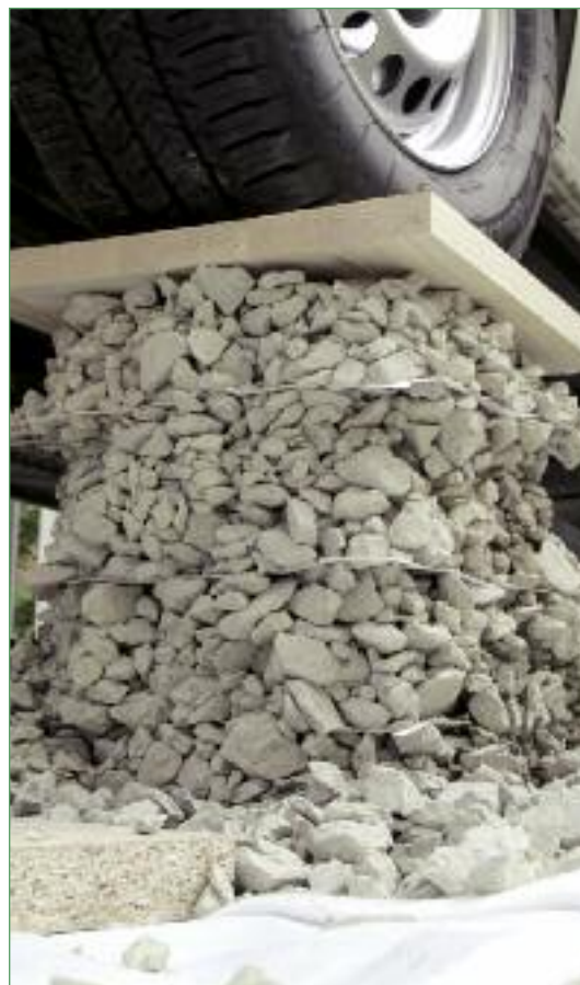
Фиг. 10 Демонстрация на ефекта на сцепление чрез автомобил, стоящ върху чакълена колона, укрепена със Secugrid®.
