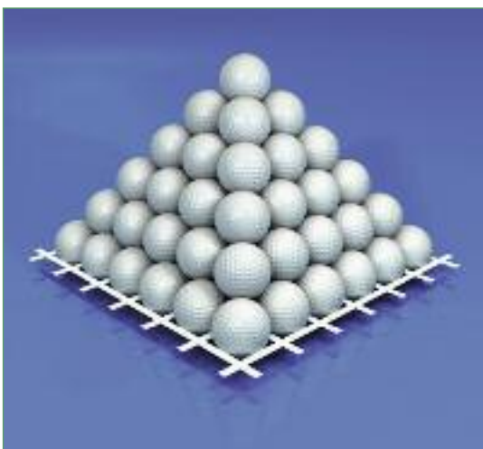
Фиг. 9 В основата на принципа на работа на Secugrid® е сцеплението със засипката и закотвянето в нея (тук това е нагледно показано с топки за голф).
