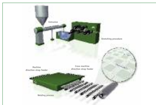
Фиг.5 Производствен процес Secugrid®
