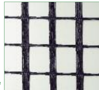
Фиг.3 Възел / тъкана геомрежа
