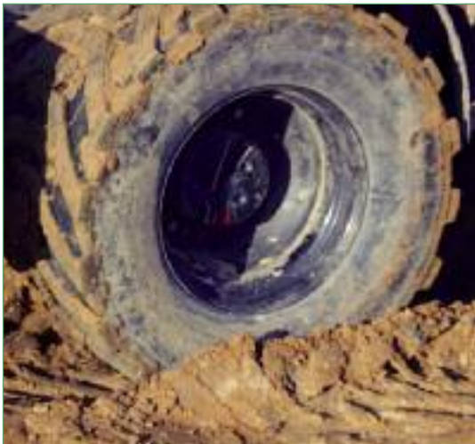
Фиг. 16 Колелата на в слаби почви образуват коловози
